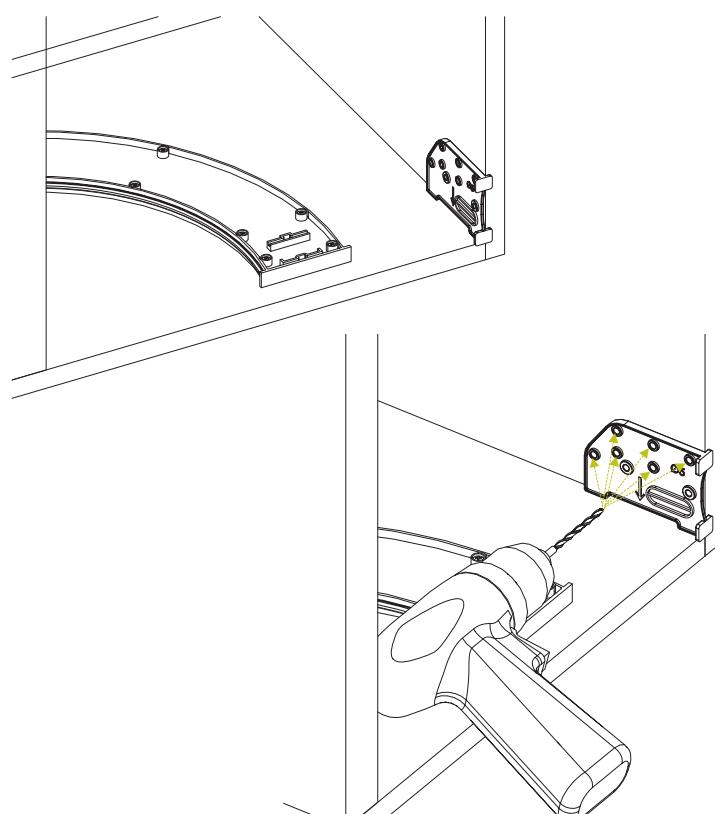
Effectuer le pré-perçage sur le côté de l'armoire en utilisant le gabarit de montage I ou en respectant les mesures et fixer ensuite les mécanismes C sur l'armoire à l'aide des eurovis fournies, insérer la bague en plastique dans le mécanisme C.
